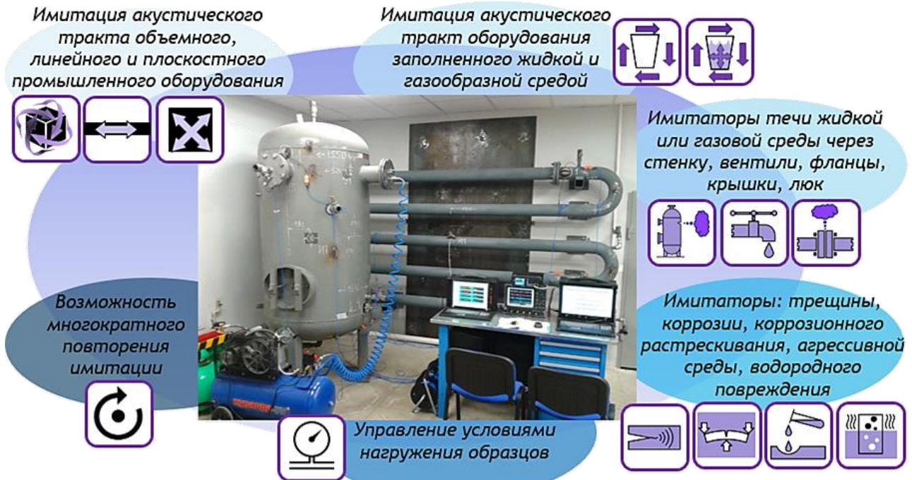
Рисунок 9 – Общий вид УУИС со схематичным отображением его отличительных особенностей при имитации повреждений статически нагруженного оборудования
